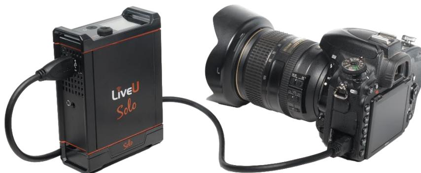
*Рисунок 27: Подключение Solo к камере DSL по HDMI*
