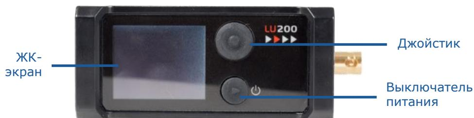
**Рисунок 6: LiveU Solo – Передняя панель**
