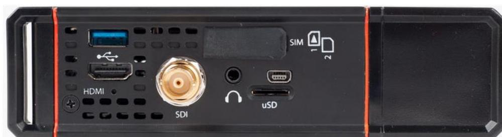
**Рисунок 26: Входы Solo (SDI/HDMI) для подключения камеры**
