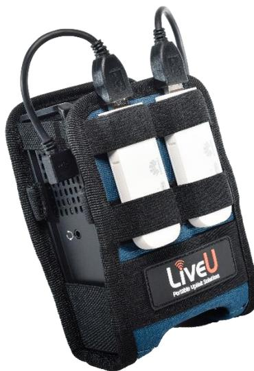
*Рисунок 28: Подключение внешних модемов к разъемам USB*
